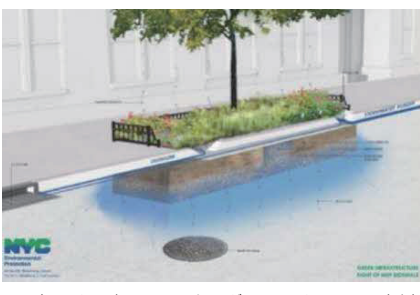
NY市レインガーデンによるグリーンインフラの事例
